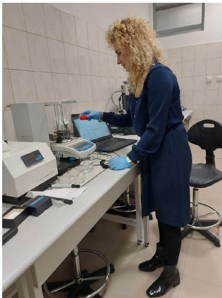
Fotografia 13. Ocena napięcia powierzchniowego cieczy (zaprawy) z wykorzystaniem tensjometru cd.
