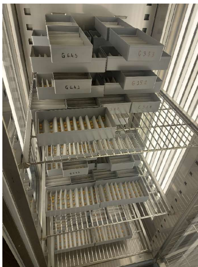
Fotografia 19. Test energii i zdolności kiełkowania wg ISTA. Testy w fitotronie
